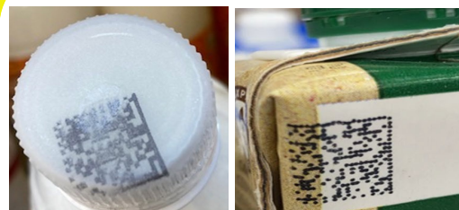
Смещение кода маркировки при печати
