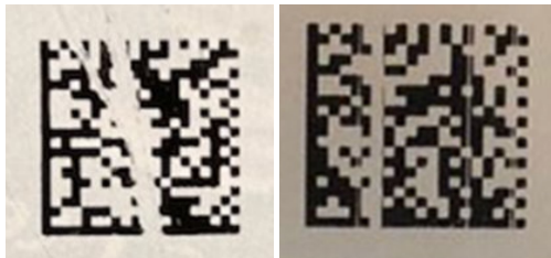
Нарушение целостности КМ*
