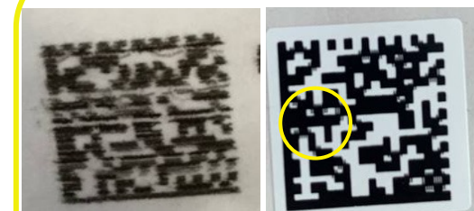
Смазывание кода маркировки или его отдельных элементов
