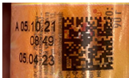
Печать кода маркировки на бликующей/светоотражающей поверхности
